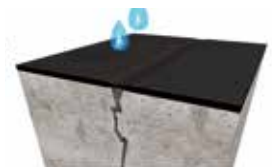
Scheuroverbruggende waterdichting: In dit geval is de laagdikte en de elasticiteit van de waterdichting bestand tegen permanente waterdruk.
